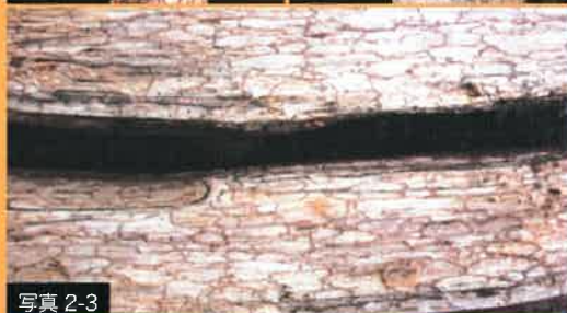
写真2-1～2-3 蜂の巣状の様相を呈した腐朽材
